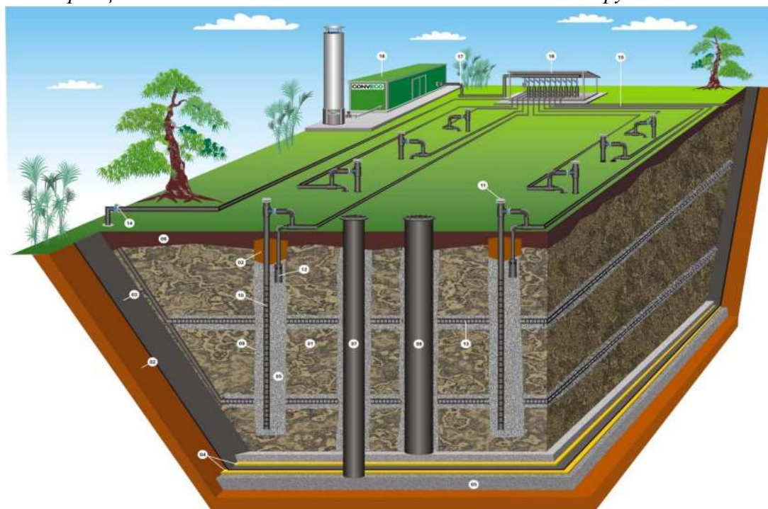
Рис.3. Общий вид в сечении полигона ТБО
