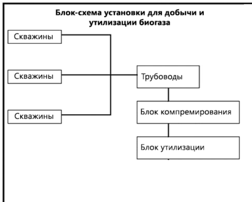
Рис.2. Принципиальная технологическая схема системы по сбору свалочного газа
