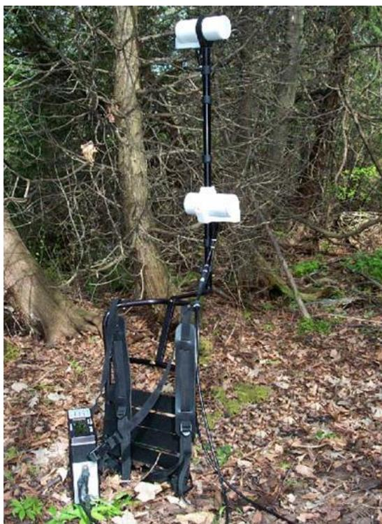
Рисунок 5.2. Магнитометр GSM-19 в рабочем положении
