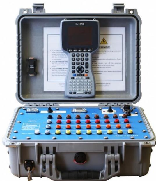
Рисунок 5.4. Измеритель ВП GDD IP GRx8-32
