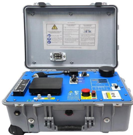
Рисунок 5.5. Электроразведочный передатчик GDD Tx4
