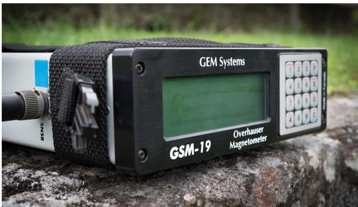
Рисунок 5.3. Приемник-регистратор GSM-19
