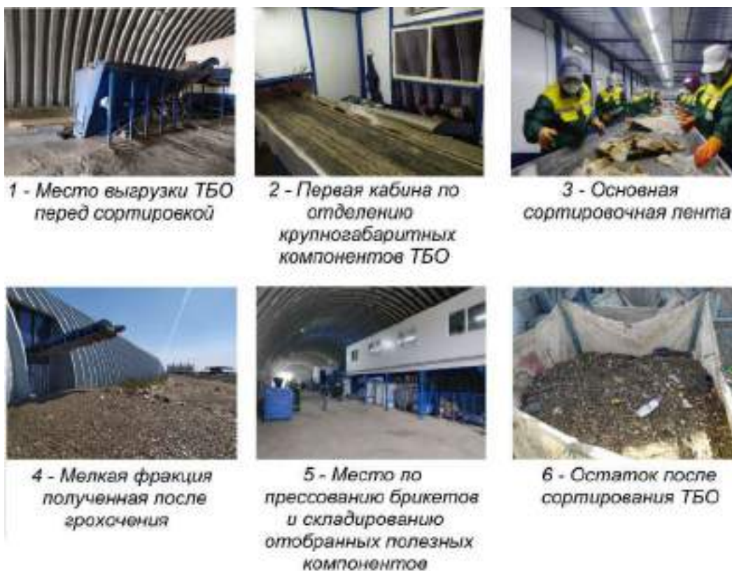
Рис. 9.3. Поэтапная сортировка ТБО (г. Атырау, ТОО «Спецавтобаза»)
