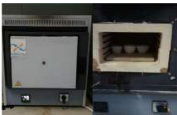
Рис. 5.8. Фотография муфельной печи с терморегулятором, предназначенного для исследования зольного остатка
