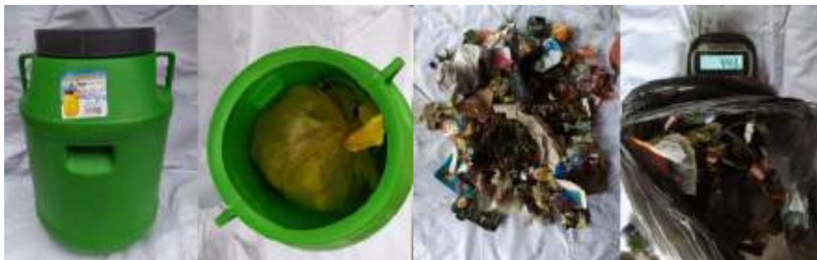
Рис. 8.9. Фотографии контейнера с ТБО-пробой, после вскрытия контейнера и при взвешивании общей массы пробы
