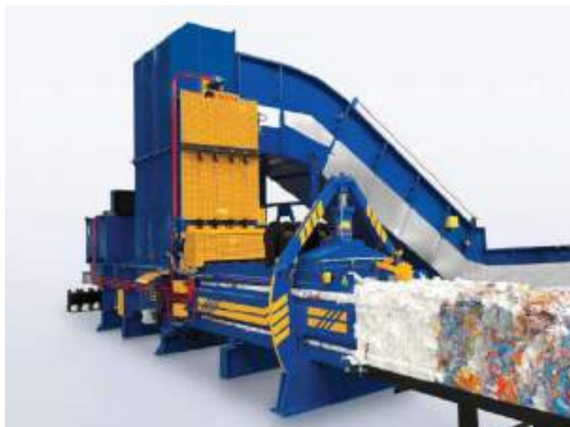
Рисунок 4.23. Пресс-сборщик с собранными пластиковыми тюками
