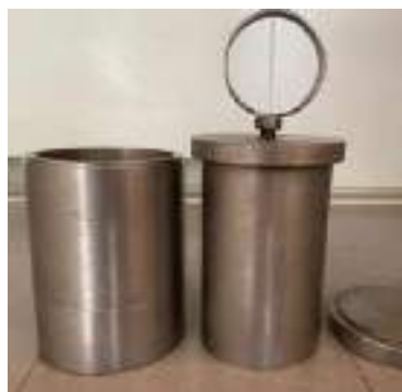
Рис. 5.10. Фотография пресс-формы и пробы ТБО в цилиндрической пресс-форме для определения компрессионных свойств
