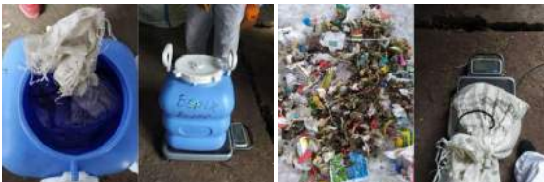
Рис. 10.4. Фотографии контейнера с ТБО-пробой, после вскрытия контейнера и при взвешивании общей массы пробы (г. Тараз)
