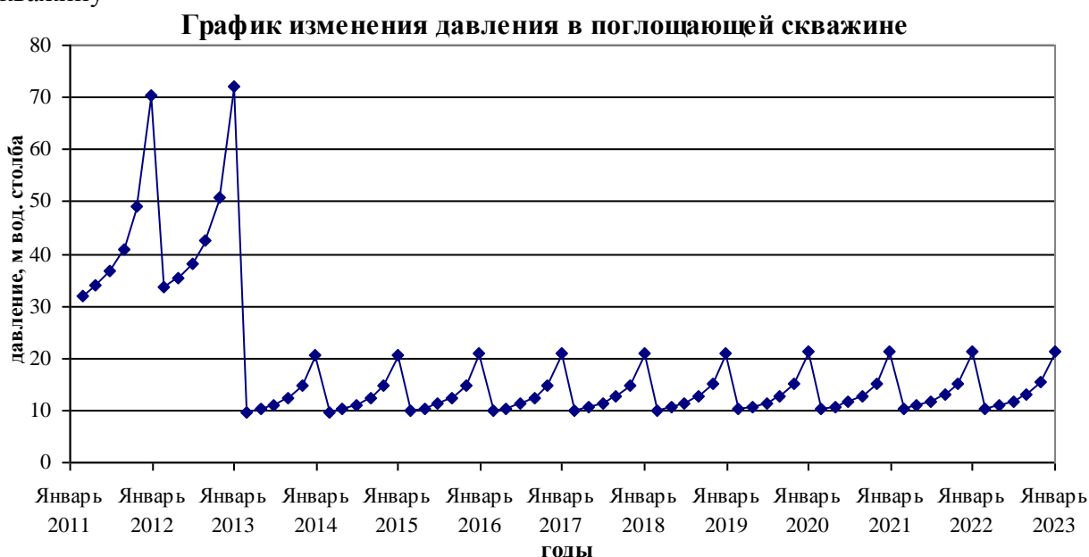
Рис. 1.8-График изменения давления в поглощающей скважине
