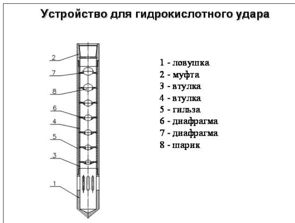
Рисунок 7-6 Устройство для гидрокислотного удара
