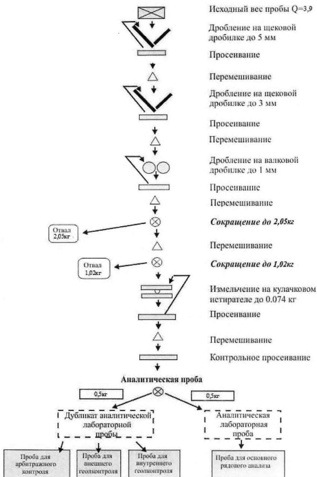
Рис. 4.1 Схема обработки бороздовых и керновых проб
