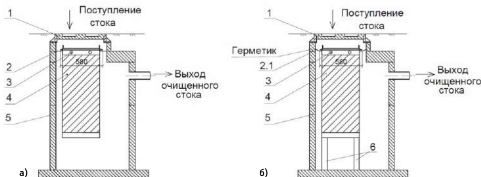
Рисунок 4. Схема установки фильтр-патрон \varnothing 580 мм под люком на бетонной плите перекрытия колодца
