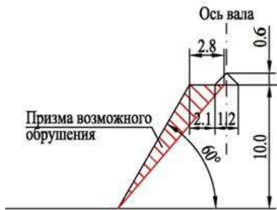
Рисунок 3.1 – Призма возможного обрушения
