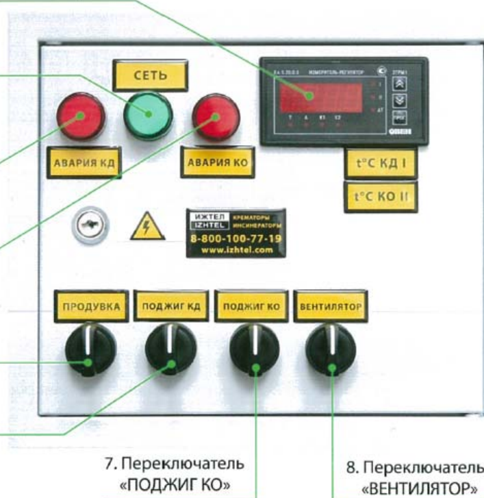
Рисунок 3 – Панель управления инсинератором.
