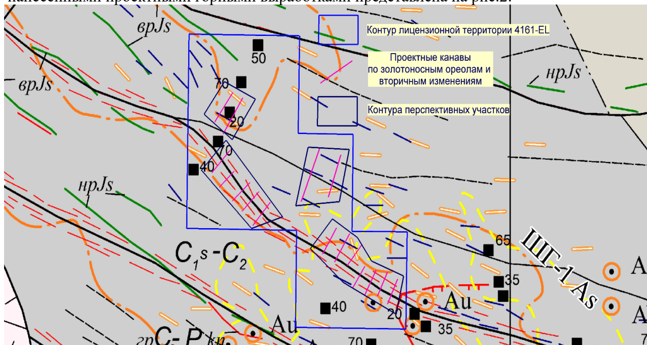
Рис.2 Схематическая карта расположения вторичных ореолов и полезных ископаемых с нанесёнными проектными горными выработками
