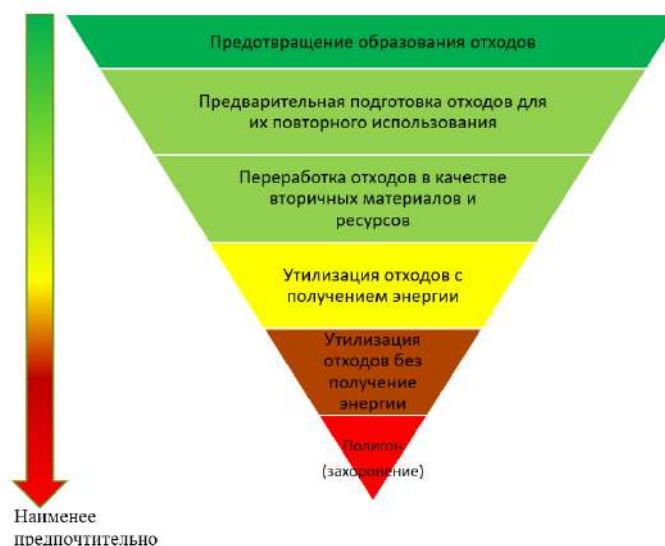
Рисунок 10 - Иерархия управления отходами
