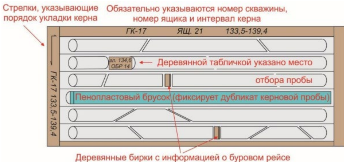
Рисунок 6.3 — Схематическое изображение керна ящика и видов отбираемых проб отобраны различные виды проб
