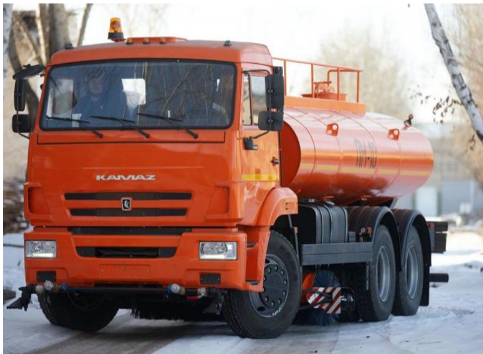
Рис. 5.6. Водополивочная машина на базе КАМАЗ-65115
