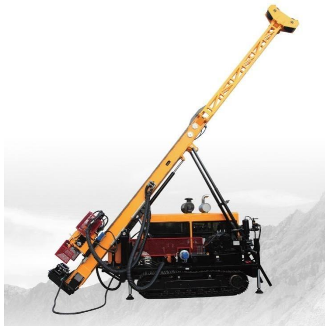
Рис. 5.12. Буровая установка «Fully hydraulic core drilling»
