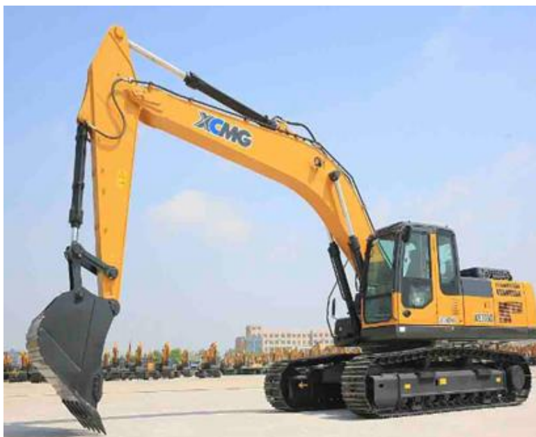
Рис. 5.11 Экскаватор XCMG HE335C с навесным оборудованием
