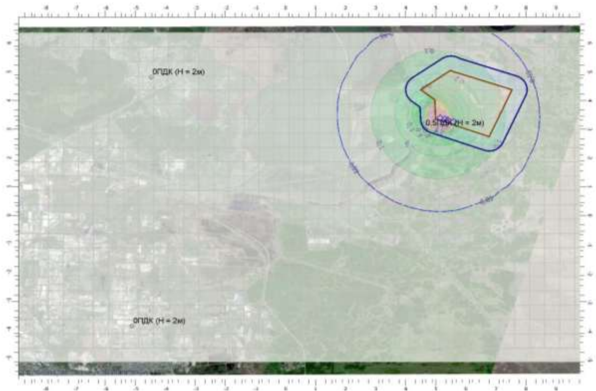
Рисунок 5.3. Карта рассеивания пыль неорганическая \text{SiO}_2 70-20 % (2908) без фона
