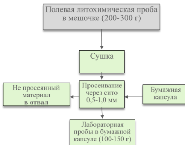
Рис. 2. Схема первичной обработки литохимических проб.
