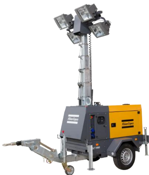
Рис. 6 - Осветительная мачта типа Atlas Copco QLT H50
