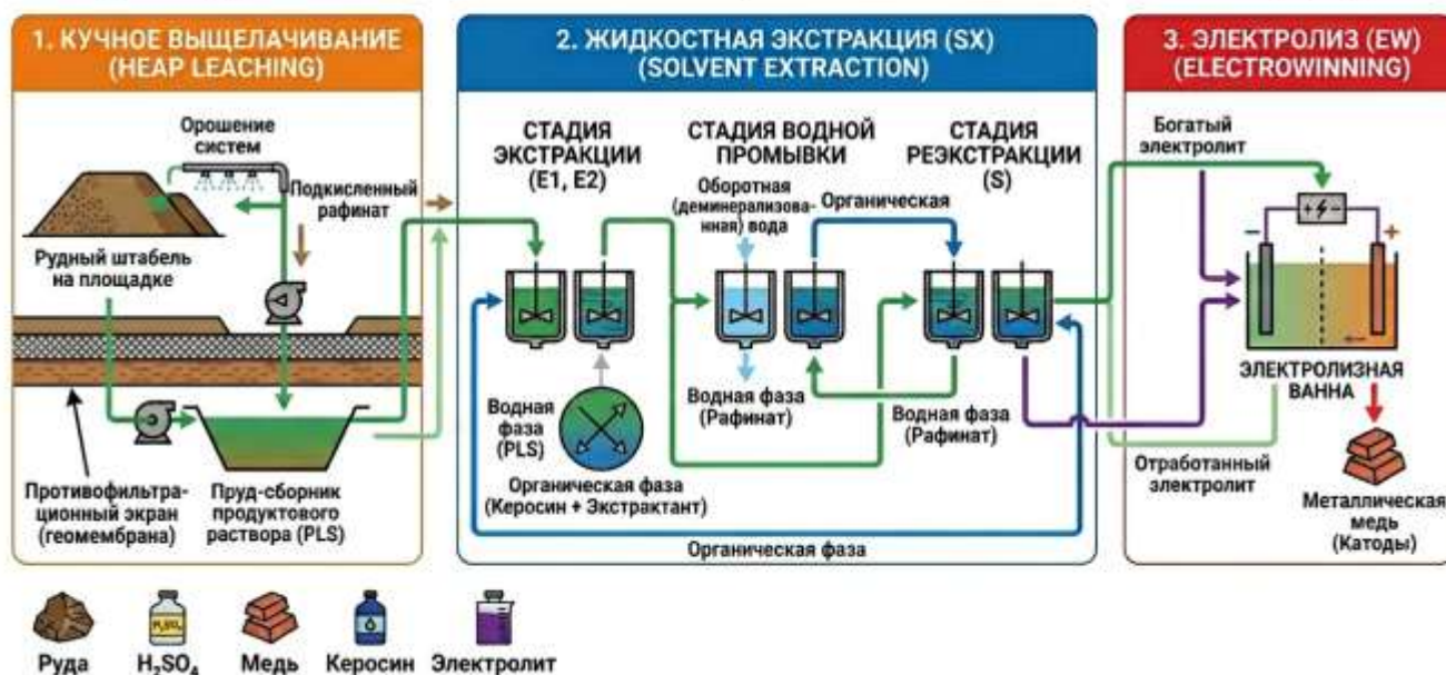
Рисунок 2. Принципиальная технологическая схема процесса (кучное выщелачивание – жидкостная экстракция – электроосаждение)
