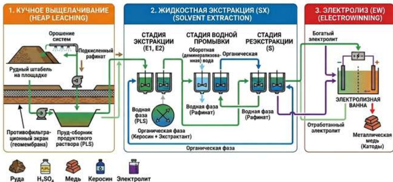
Рисунок 22.3.1 Принципиальная технологическая схема процесса (кучное выщелачивание – жидкостная экстракция – электроосаждение)
