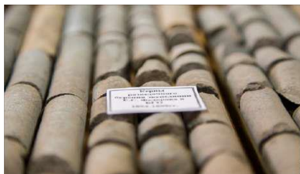
Установка бирок выхода и проходки
