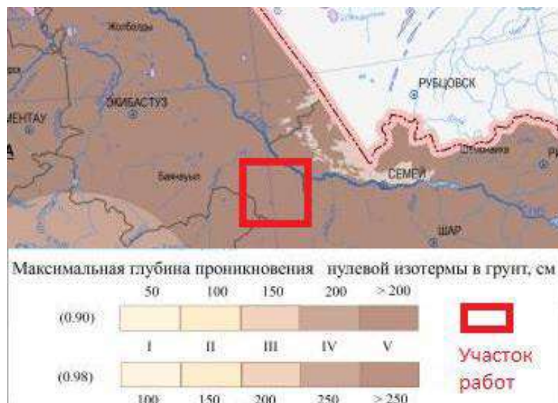
Рисунок 5 – Фрагмент карты максимальной глубины проникновения нулевой изотермы в грунт
