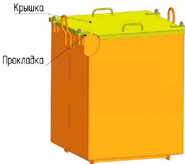
Рисунок 20 – Контейнер для отходов
