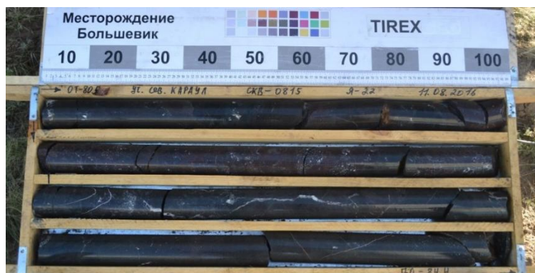
Рис.9 Пример линейки и цветной/черно-белой контрольной полосы, для корректировки цветового баланса при фотографировании керна
