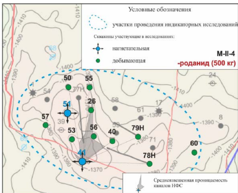
Рисунок 3.1.14 - Роза-диаграмма распределения средневзвешенных по массе проницаемостей канала фильтрации участка нагнетательной скважины №41
