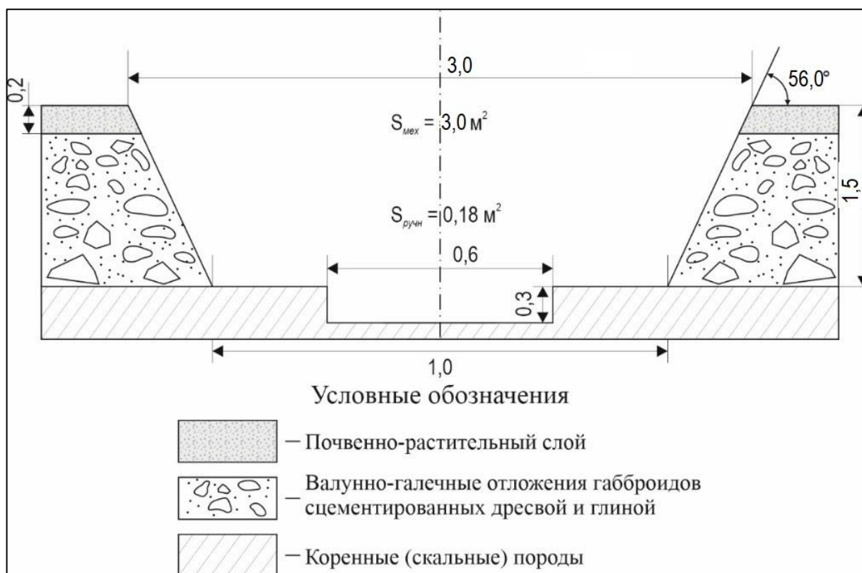
Рисунок 15. Предполагаемый геолого-технический наряд на проходку канавы
