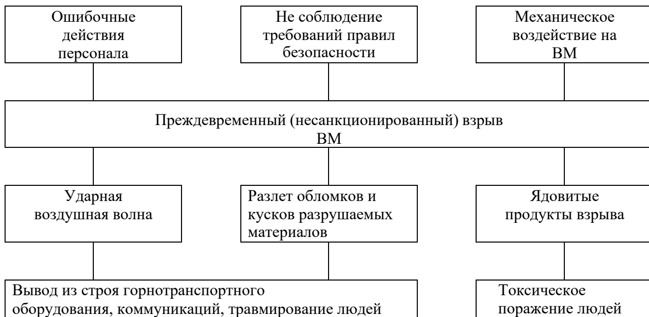
Рис.11.2 - Блок-схема вероятного сценария аварии при преждевременном (несанкционированном) взрыве ВВ при проведении взрыва в блоке с механизированным заряданием скважин
