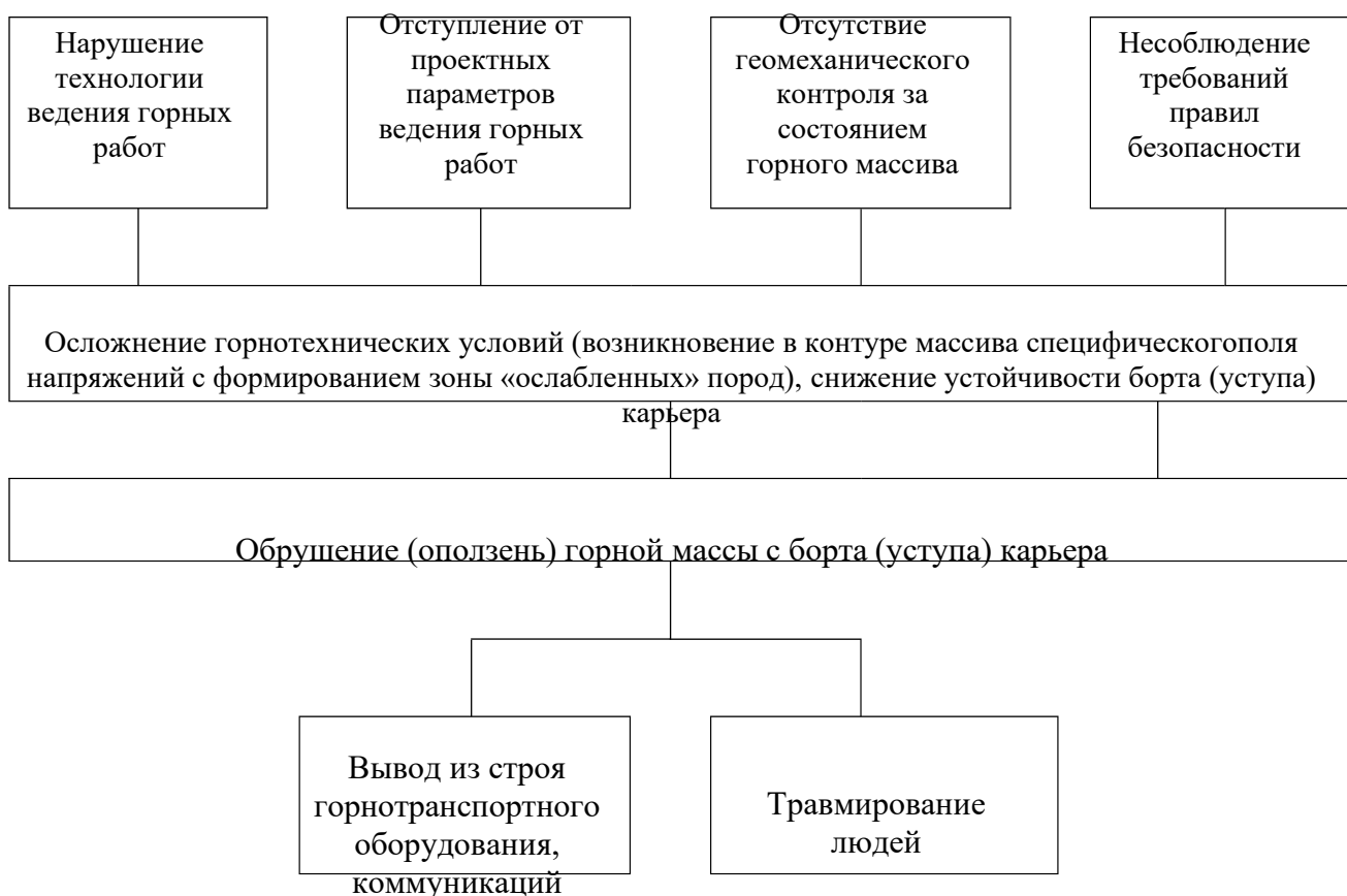
Рис.11.1 - Блок-схема вероятного сценария аварии при обрушении (оползней) горной массы с борта (уступа) карьера
