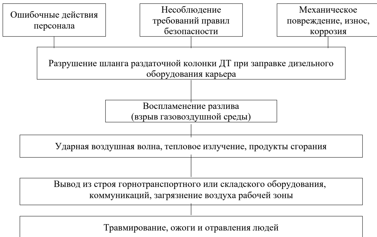
Рис.11.3 - Блок-схема вероятного сценария возникновения и развития аварии при заправке дизельного технологического оборудования карьера из топливозаправщика
