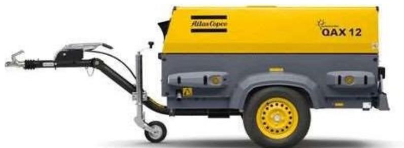
Рис. 8.2 - Передвижная дизельная электростанция типа Atlas Copco QAX 60
