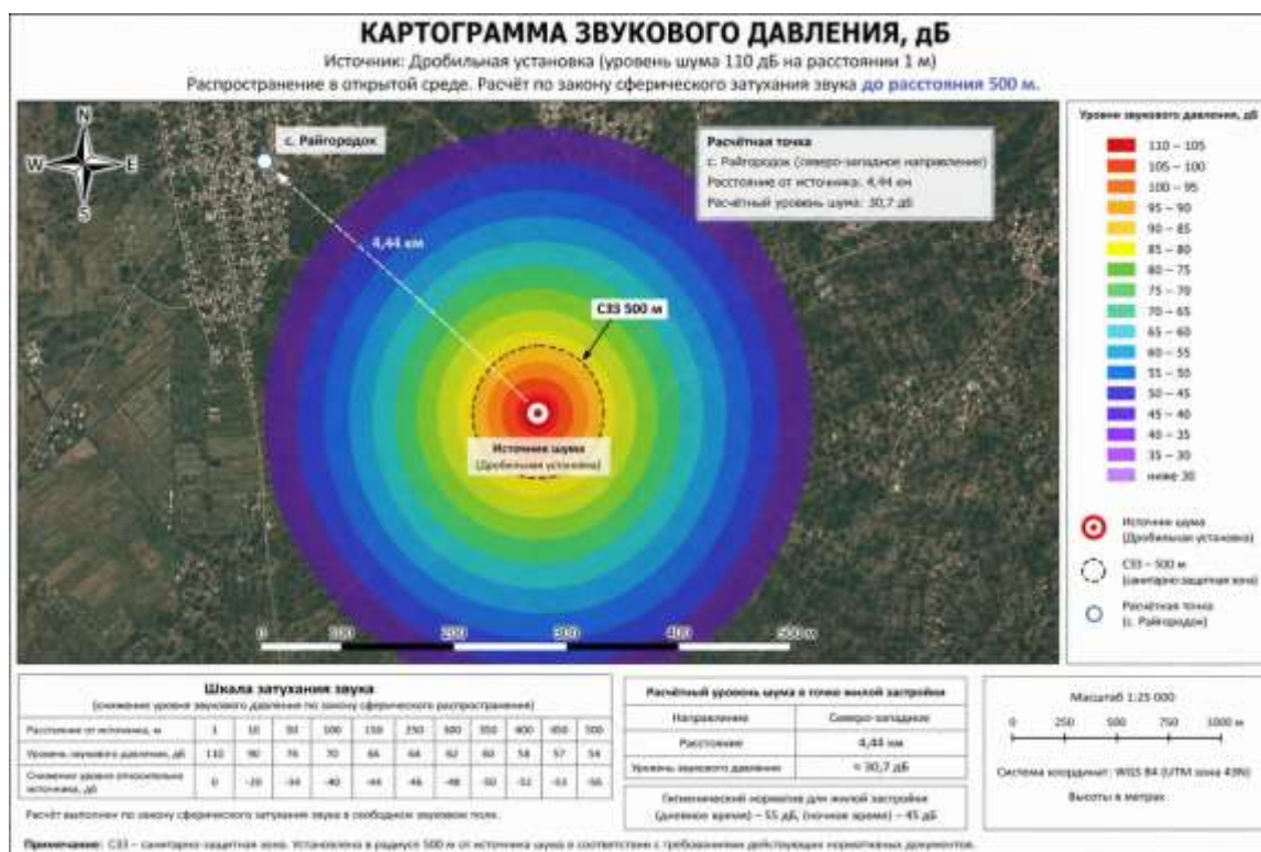
Рисунок 3.7 – Результаты расчёта затухания звука в графической форме в рабочей зоне оборудования (эквивалентный уровень звука – интегральный показатель)
