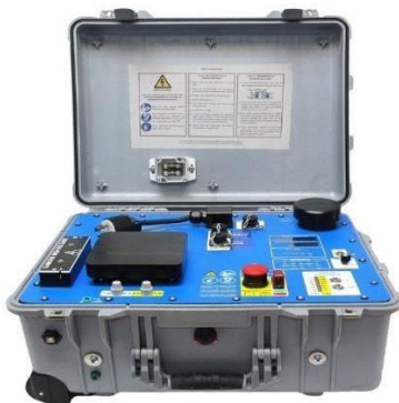
Рисунок 5.6. Электроразведочный передатчик GDD Tx4 \ Электроразведочные работы планируются проводить по сети 700 x 100 (медно-пурпуровая зона), 800x50 м (вторичные кварциты и зоны минерализации) (табл.5.4).
