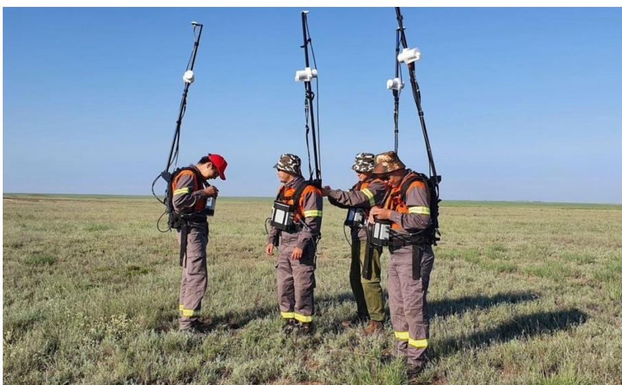
Рисунок 6.3 – Выполнение наземной магниторазведки с помощью модульного магнитометра GSM-19W (Канада)
