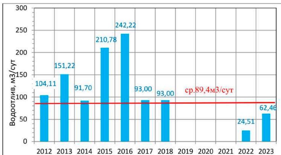
Рис.2 Изменение объёмов карьерного водоотлива за 2012-2023 гг.
