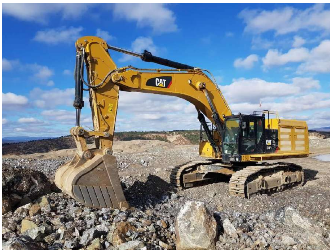
Рисунок 23 - Гидравлический экскаватор САТ-374 с ковшом 3,8 м 3
