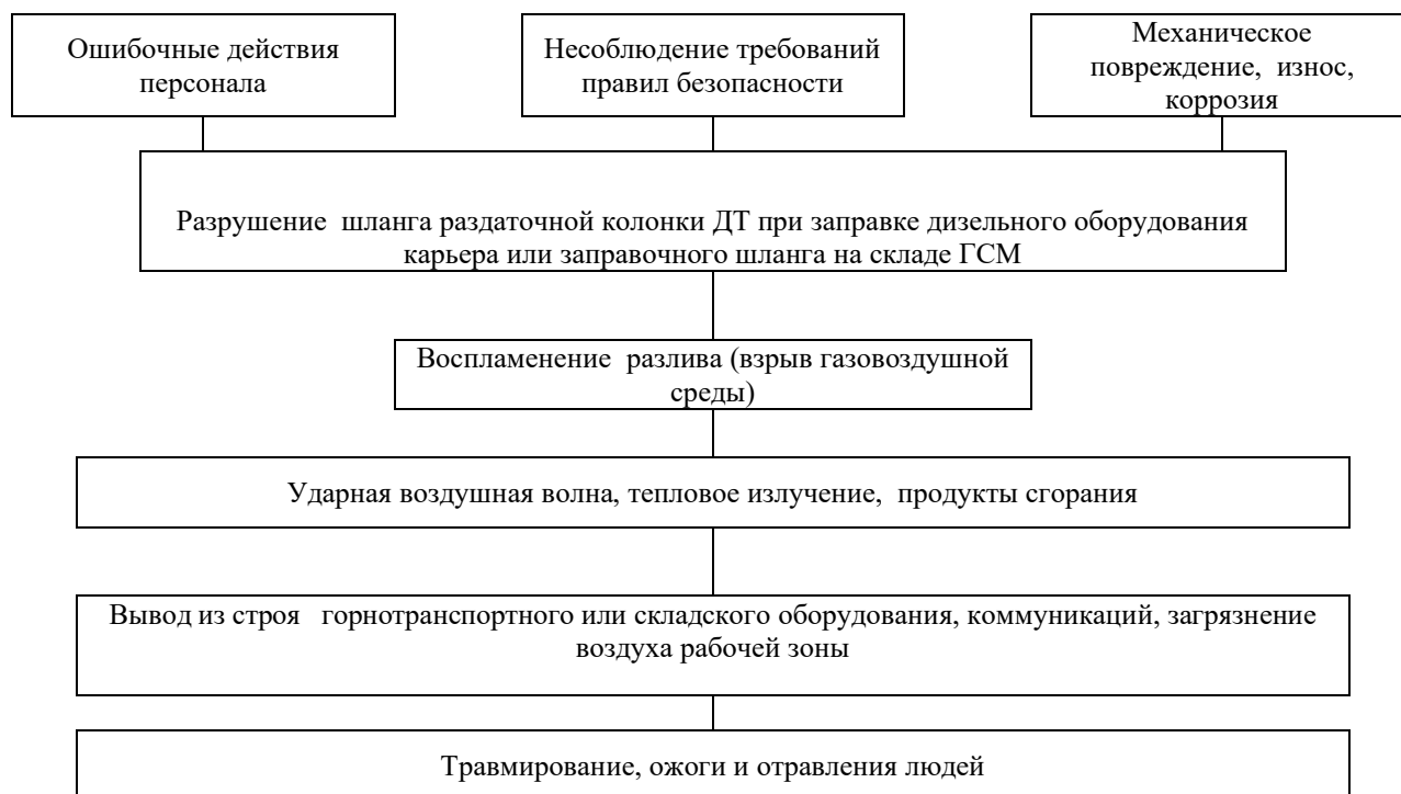
Рисунок 37 - Блок-схема вероятного сценария возникновения и развития аварии при заправке дизельного технологического оборудования карьера из топливозаправщика или заправке емкости на складе ГСМ
