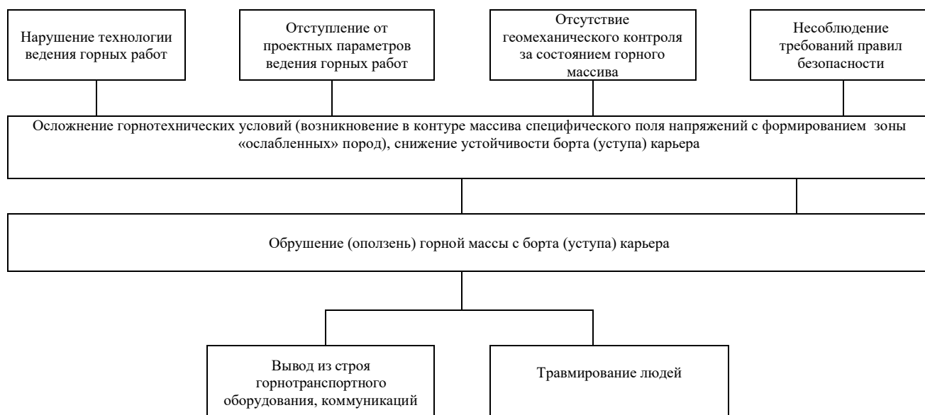
Рисунок 35 - Блок-схема вероятного сценария аварии при обрушении (оползней) горной массы с борта (уступа) карьера
