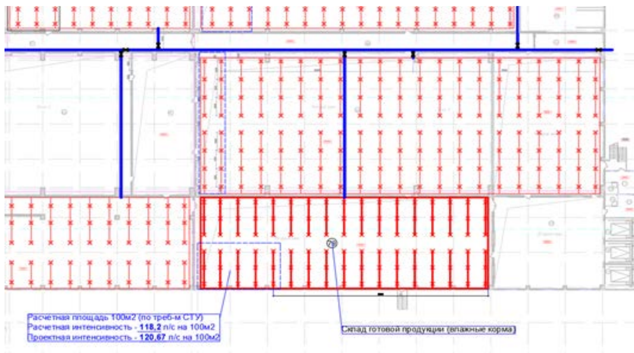
Рис.1 План расстановки оросителей для пом. 79 – склада готовой продукции для влаж.кормов
