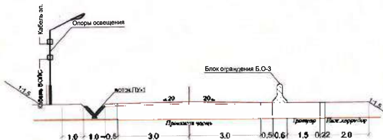
Рис. 5.3. Поперечный профиль Тип 3 (схема функционального зонирования) на ПК ПК 11+30 – ПК 17+30
