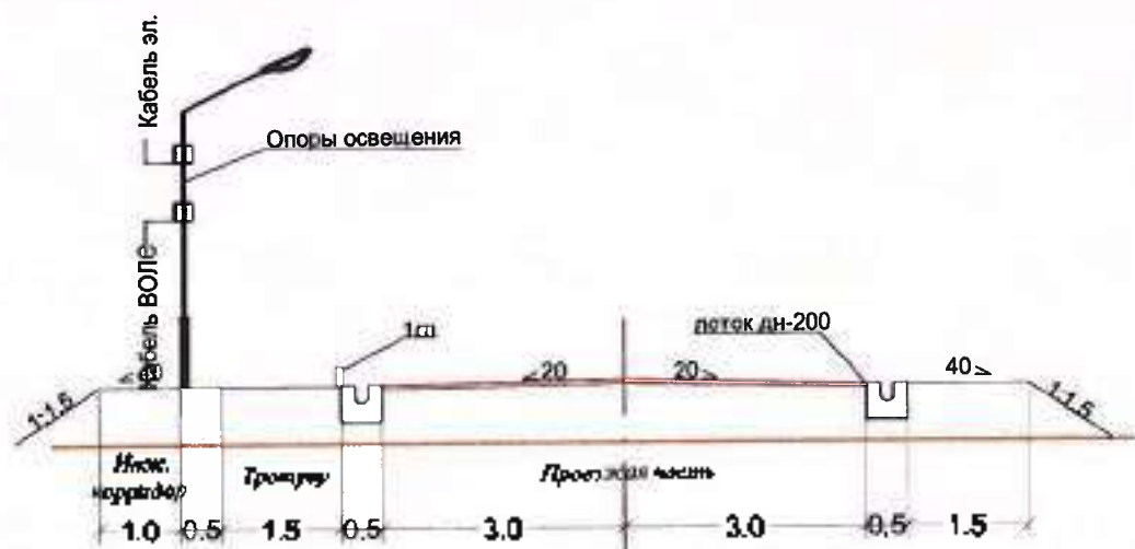
Рис. 5.2. Поперечный профиль Тип 2 (схема функционального зонирования) на ПК 4+90 – ПК 11+30
