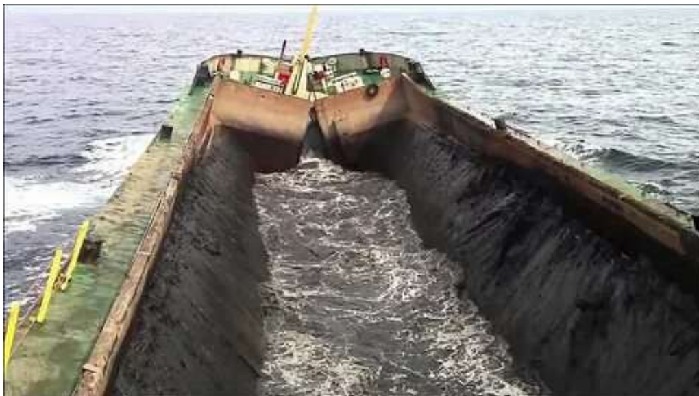
Рисунок 3.1.6 Баржа с раскрывающимся днищем
