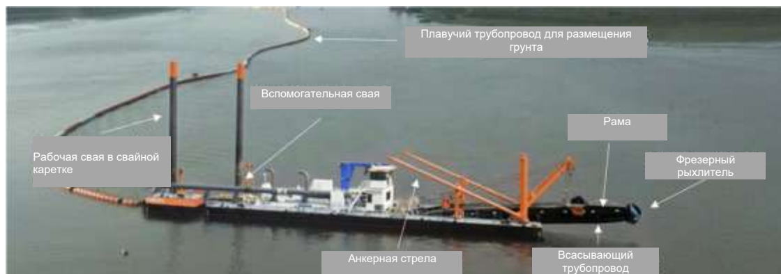
Рисунок 3.1.3 Фрезерный земснаряд
