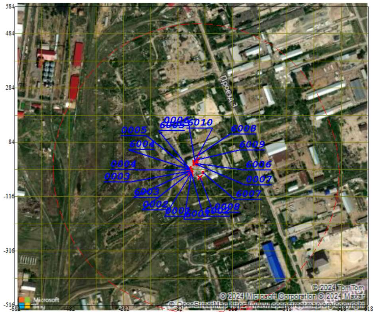
Рисунок 2 Ситуационная карта – схема с нанесенными на нее источниками выбросов в атмосферу на период эксплуатации объекта
