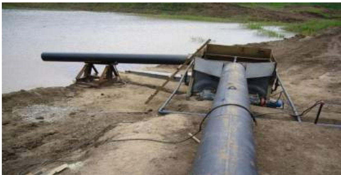
Рисунок 33 - Модернизированная установка для улавливания мелкого золота.
