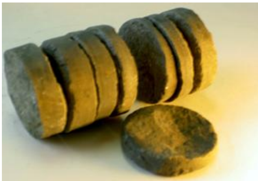
Рисунок 7.4 - Пример дискования керна при удароопасном состоянии массива
