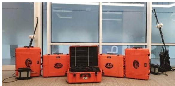
Рисунок 6.4 – Модульные магнитометры GSM-19W (Канада).
