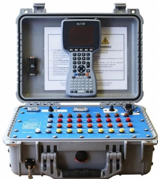
Рисунок 5.5. Измеритель ВП GDD IP GRx8-32
