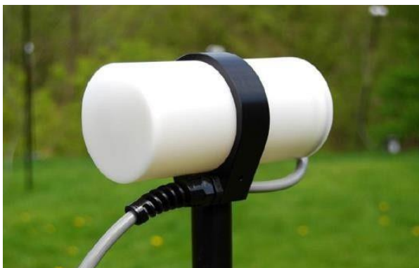
Рисунок 5.1 – Сенсор GSM-19 с обогащёнными свободными радикалами и приемник регистратор GSM- 19
