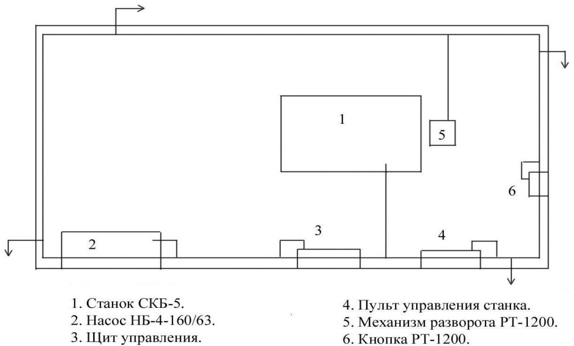
Рис. 6.8. Схема защитного заземления на буровом агрегате
