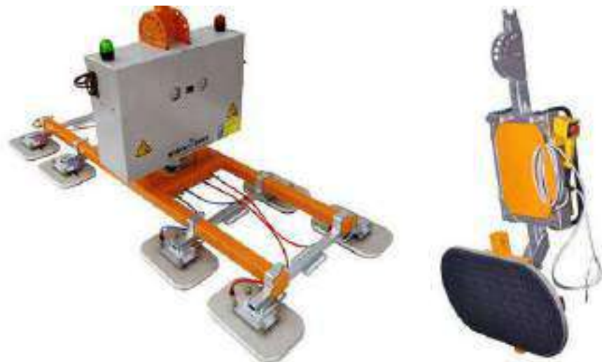
Рис. 5.9.1. Вакуумные захваты для сэндвич-панелей
