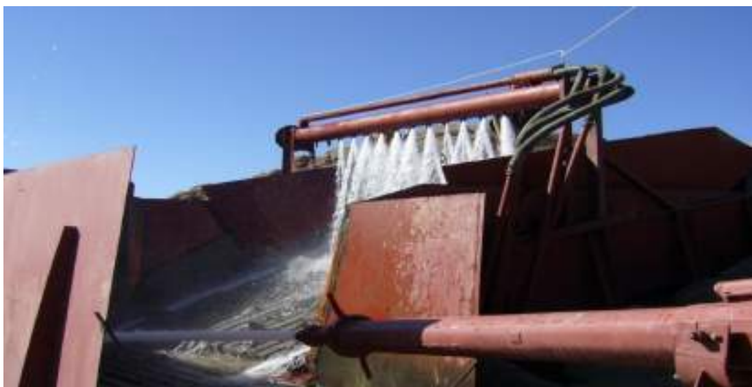
Рисунок 32 - Гидравлический двух бункерный промывочный прибор - ПГШ 60/2Б. Загрузочный бункер – грохот и розмывочный бункер – грохот.
