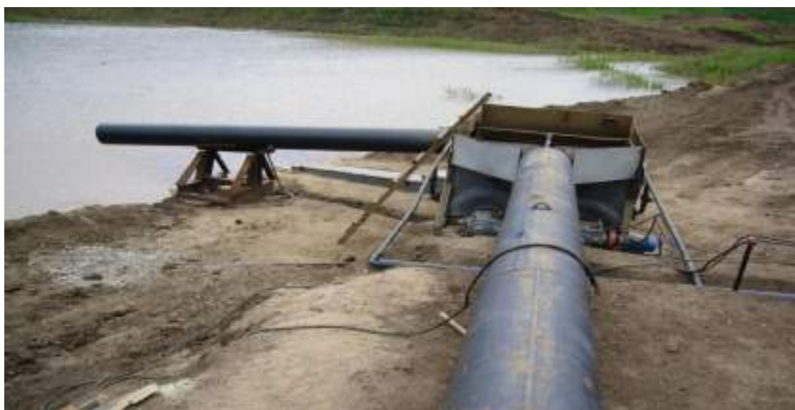
Рисунок 33 - Модернизированная установка для улавливания мелкого золота.
