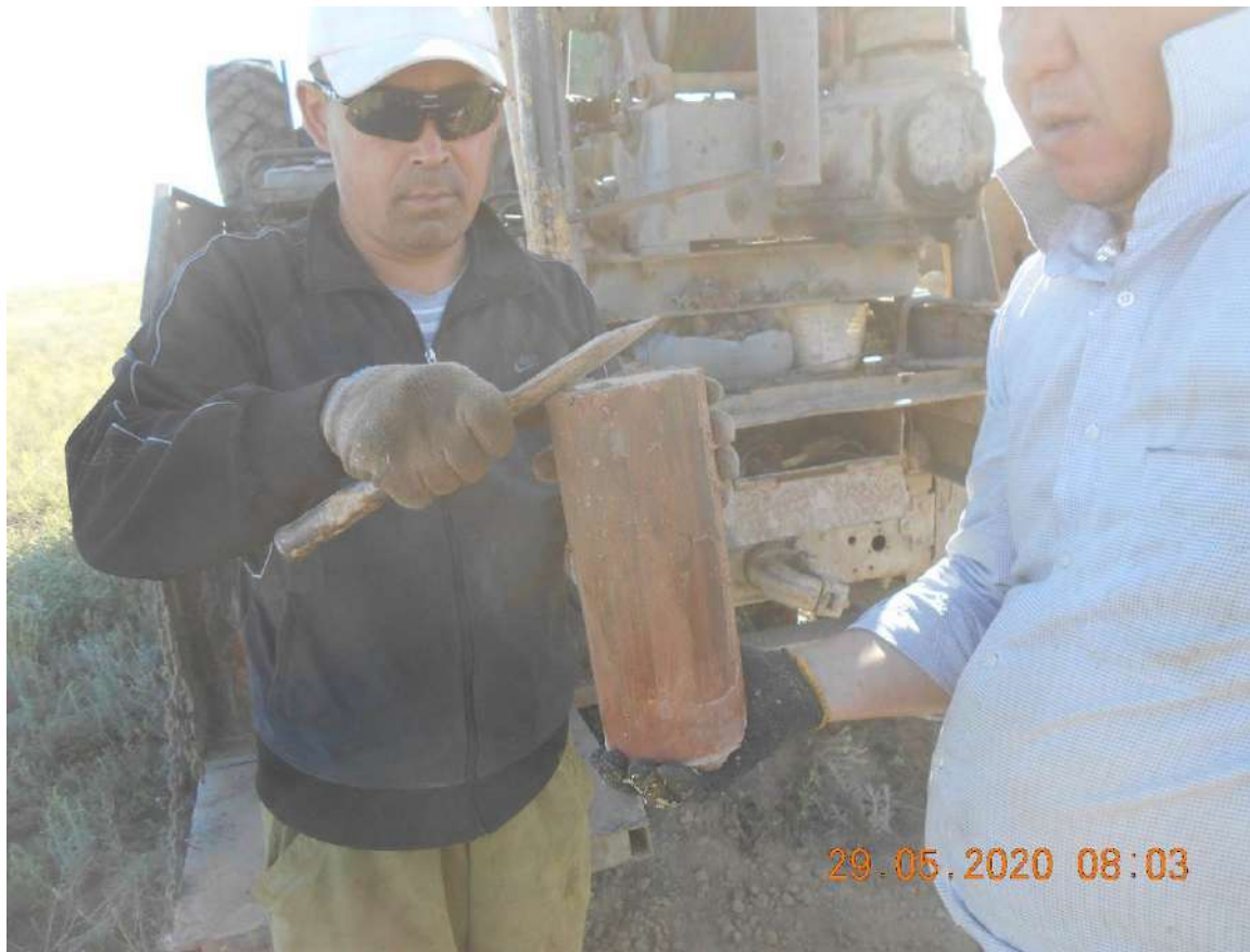
Рисунок №5 Сkv. №6 Отбор проб ненарушенной структуры.
