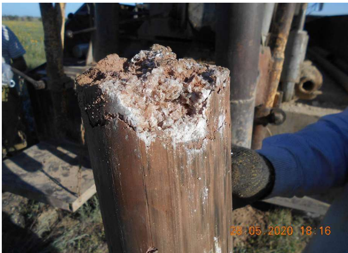
Рисунок №2 Скв. №2 Монолит с включением гнезд гипса.
