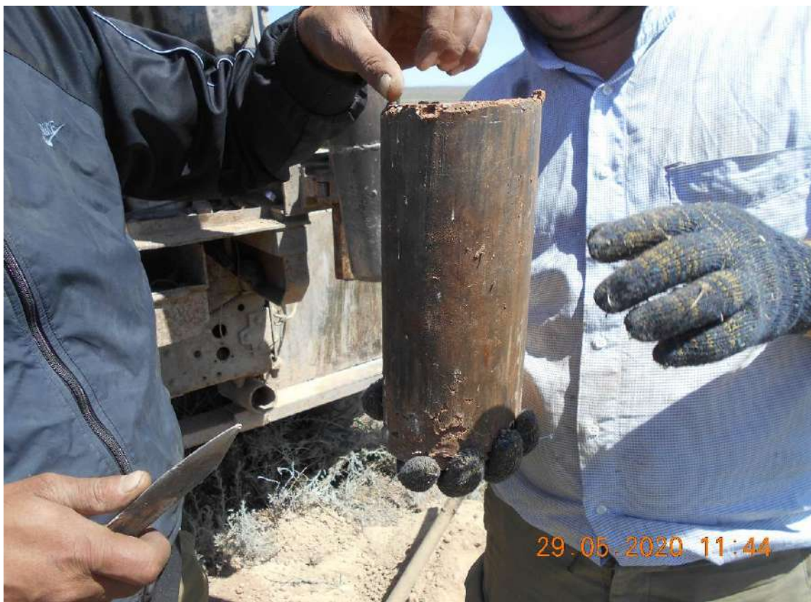
Рисунок №8 Скв. №10 Отбор проб ненарушенной структуры.
