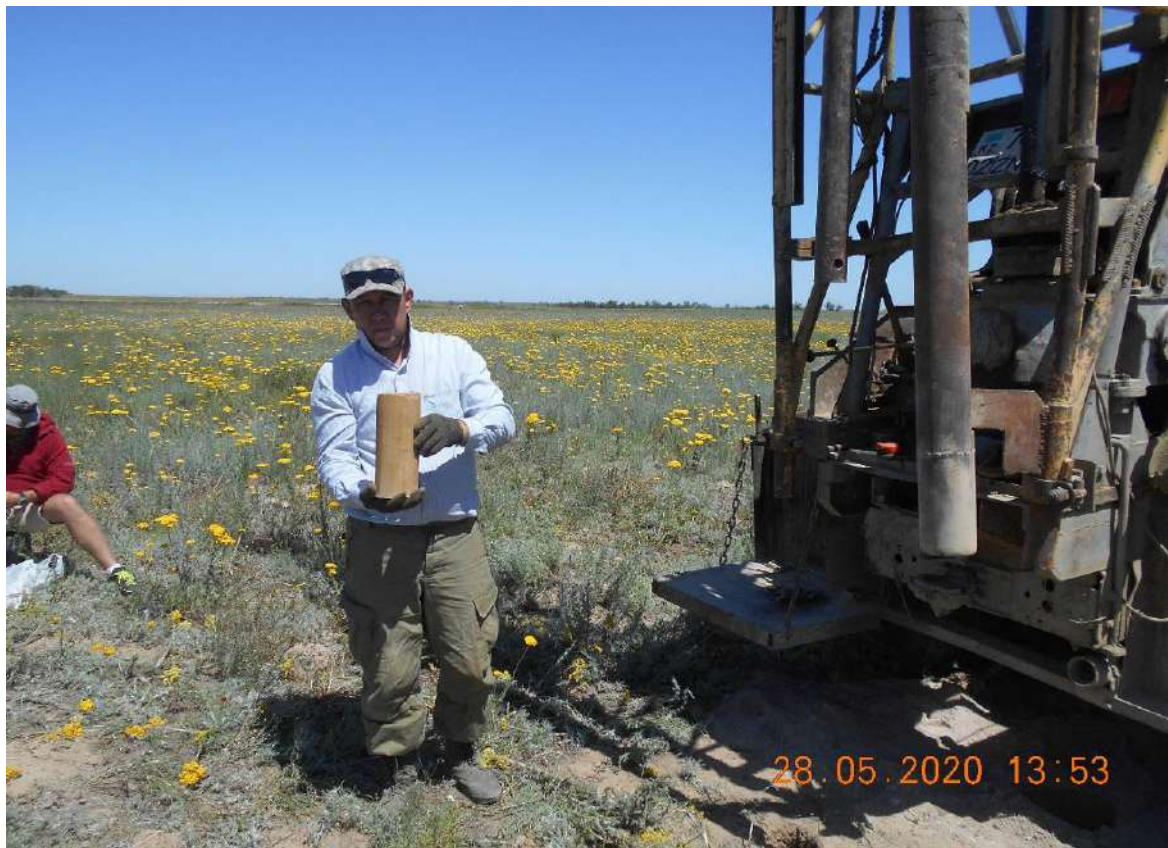
Рисунок №1 Скв. №2 Отбор проб ненарушенной структуры.
