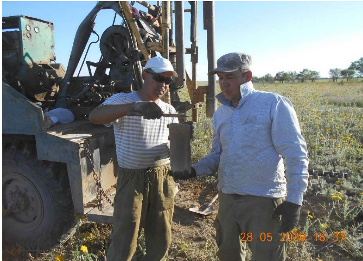
Рисунок №3 Сква. №5 Отбор проб ненарушенной структуры.
