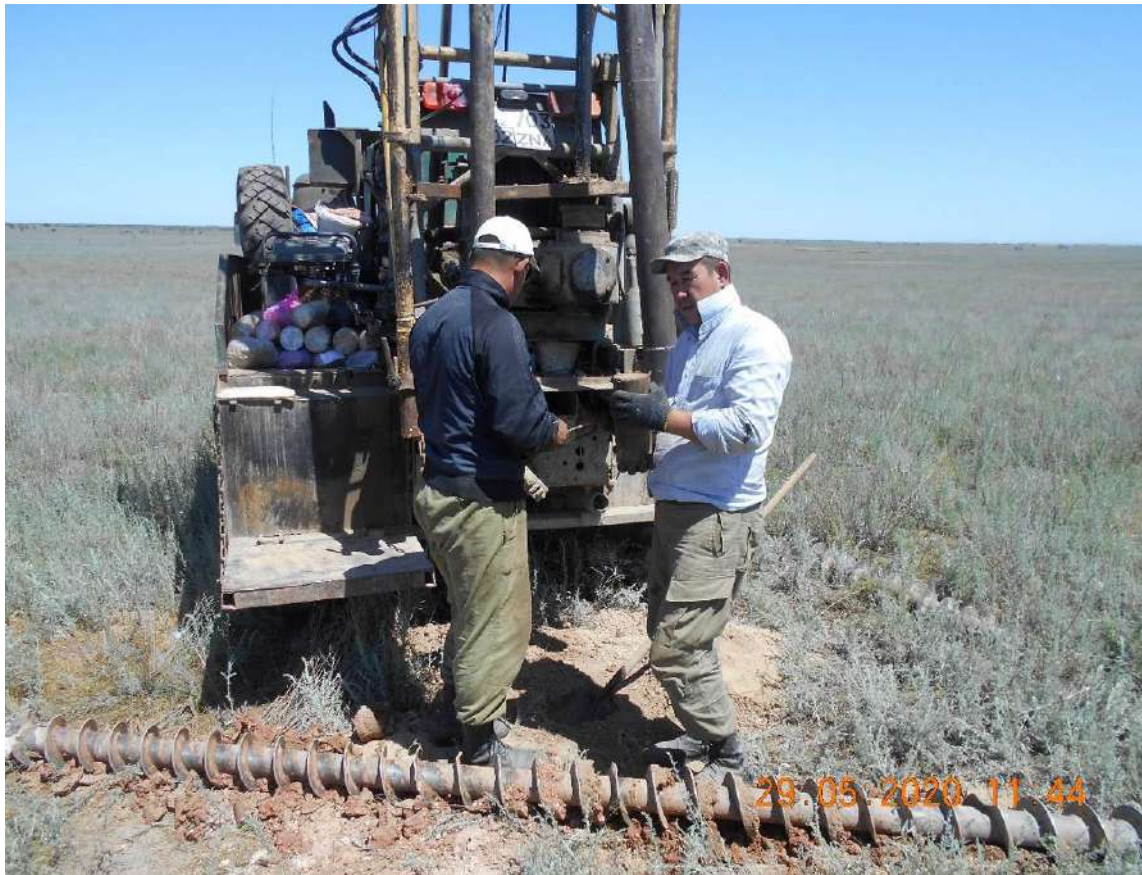
Рисунок №7 Скв. №10 Отбор проб ненарушенной структуры.
