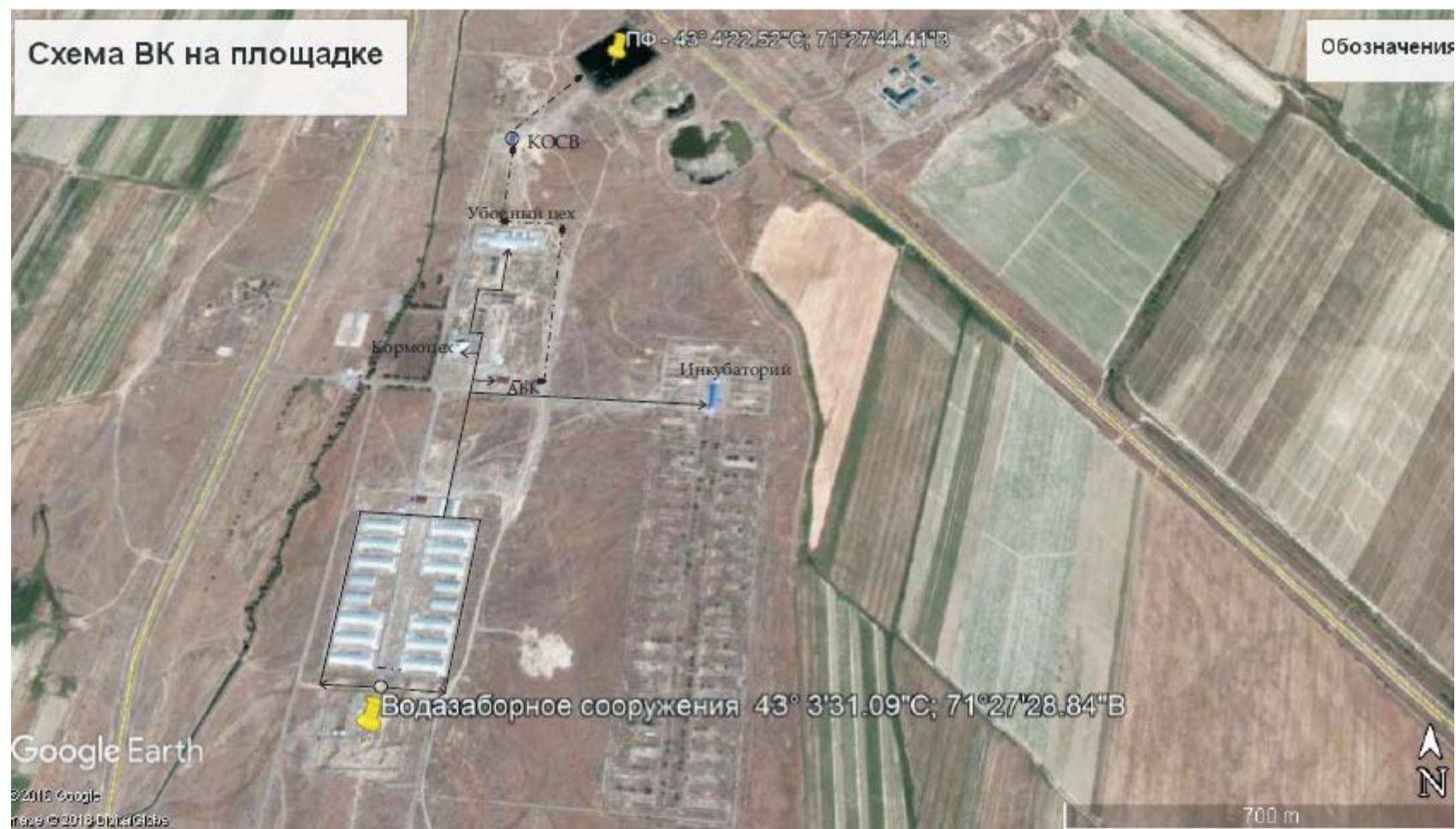
Рис. 4 Схема водопровода и канализации на площадке
