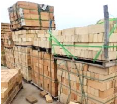
Сурет 10. Отқа төзімді бірінші дәрежелі жоғары алюминий кірпіш.
