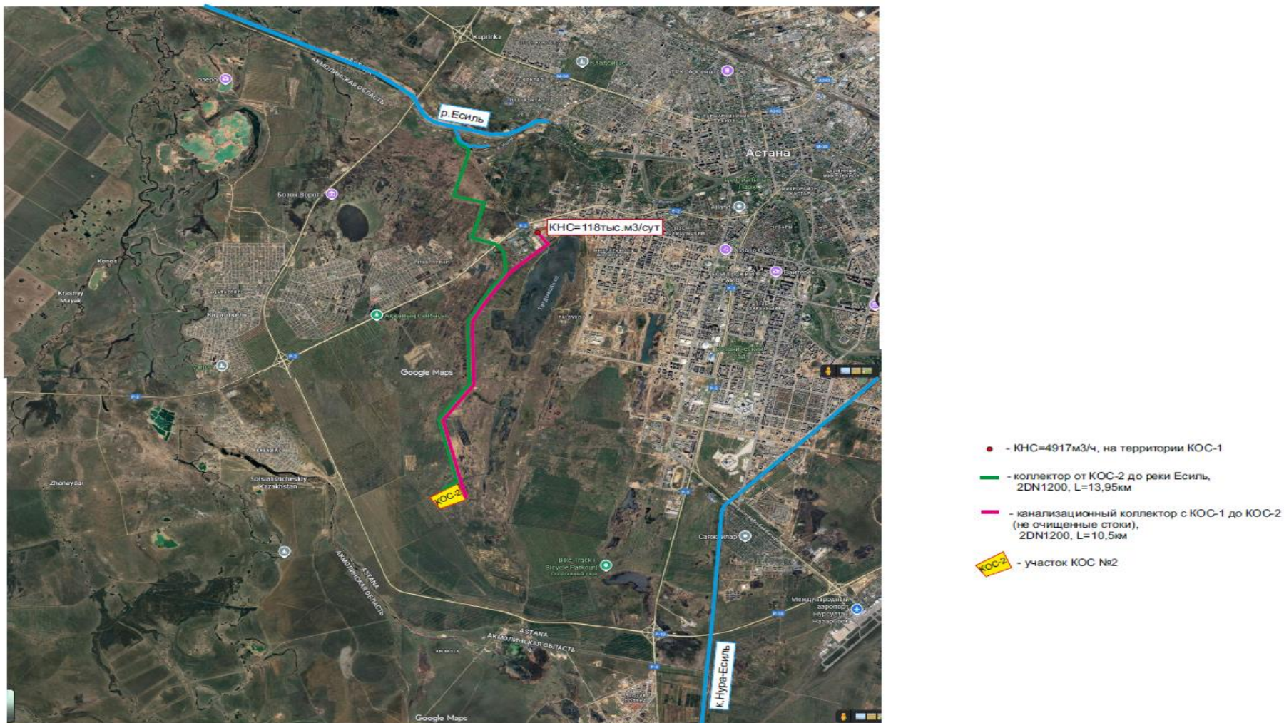
Схема канализационных коллекторов в составе проекта «Строительство канализационных очистных сооружений №2 города Астаны» г. Астана, район «Нура», район пересечения ул.Ш.Айтматова и Хусейн бен Талал»
