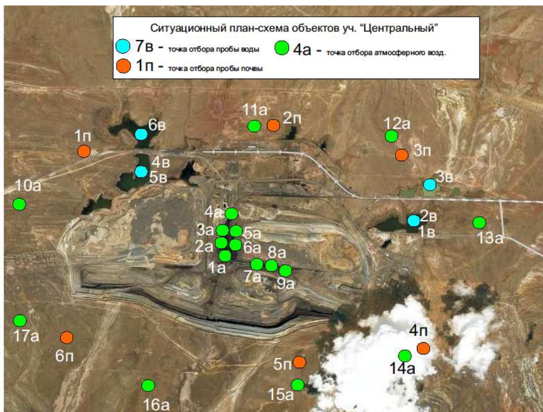
Рисунок 0.8 – Карта-схема с нанесенными точками отбора проб при проведении производственного мониторинга промплощадки №1 – «Участок Центральный» АО «Шубарколь комир»
