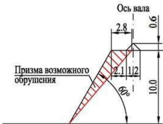
Рисунок 3.1 – Призма возможного обрушения
