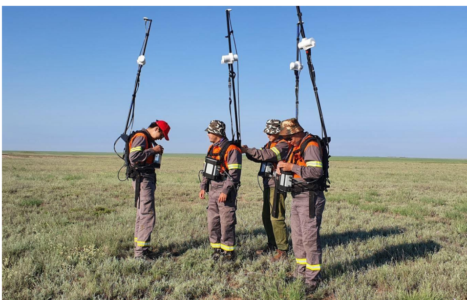
Рисунок 9.3 – Выполнение наземной магниторазведки с помощью модульного магнитометра GSM-19W (Канада)
