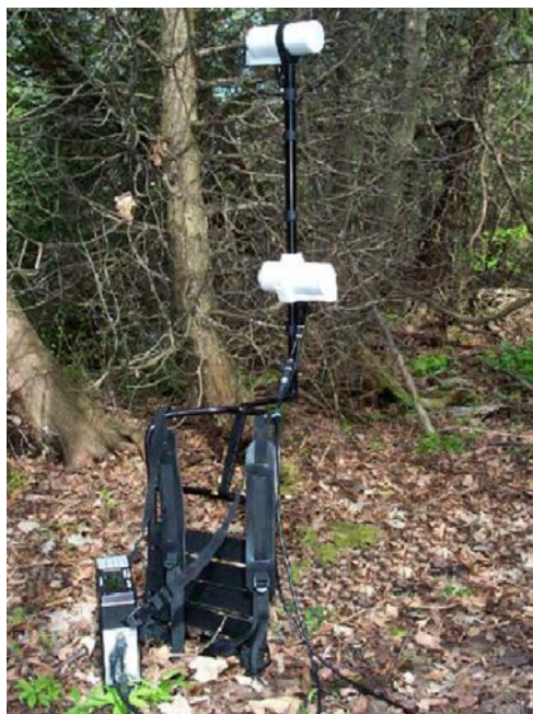
Рис. 5.11.1 Магнитометр GSM-19 в рабочем положении
