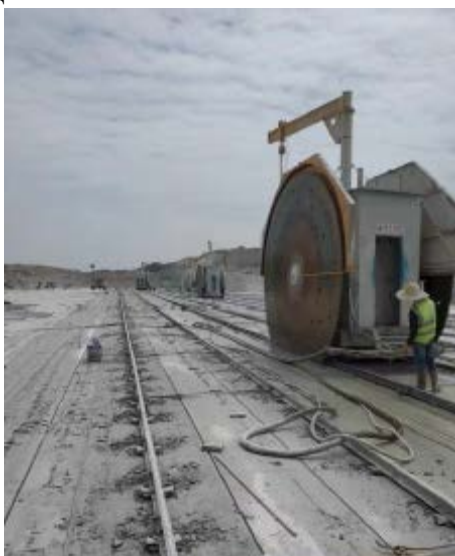
Рисунок 2.3- Схема работы камнерезных станков с двойным лезвием RSZL4200YC/1950-2450MM
