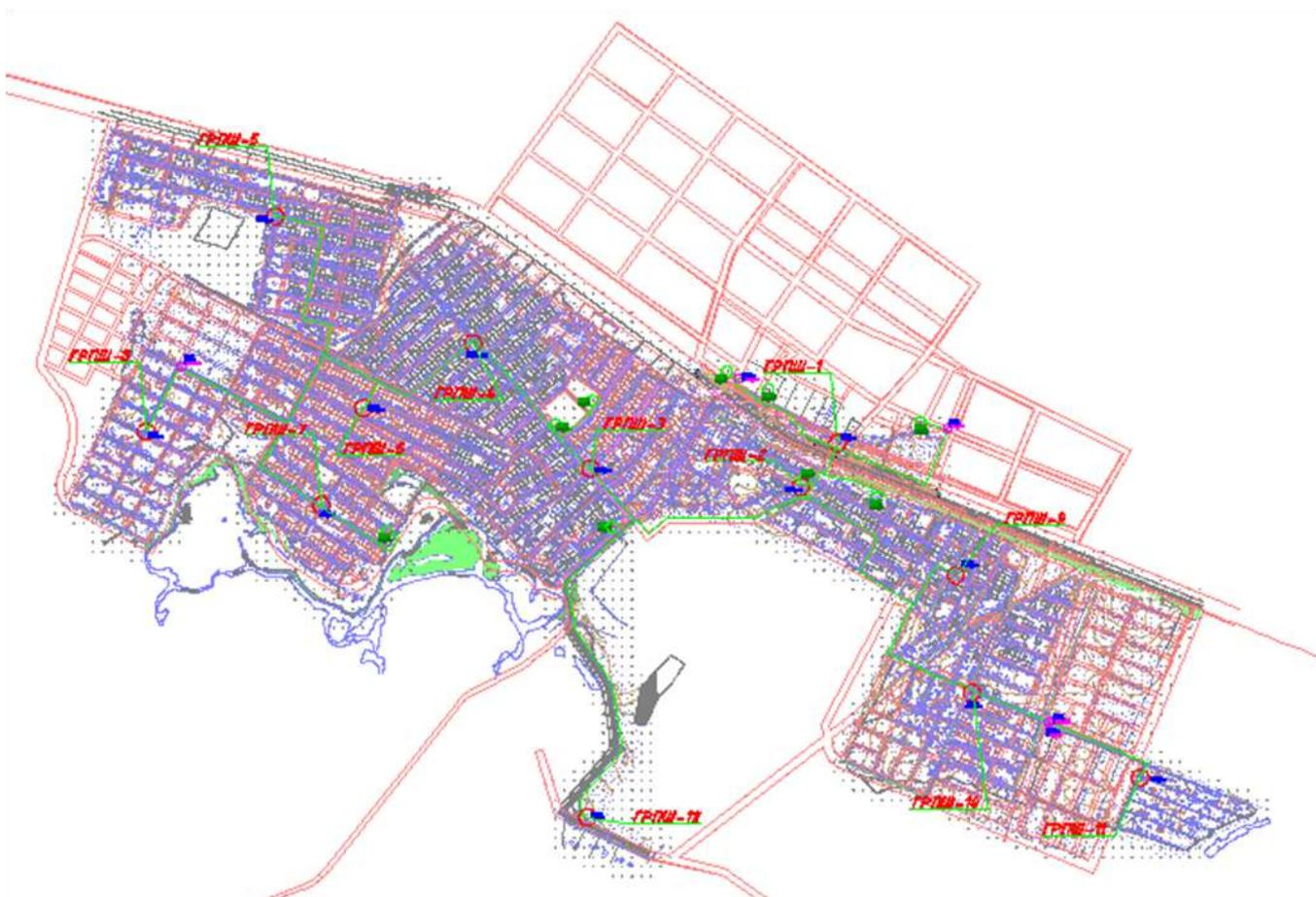
Рисунок 1. Ситуационный план газоснабжения с. Талапкер
