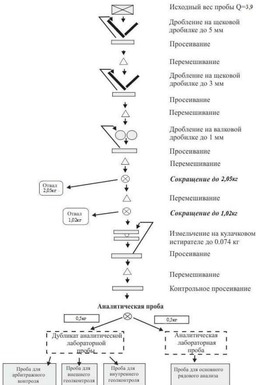
Рис. 4.1 Схема обработки бороздовых и керновых проб
